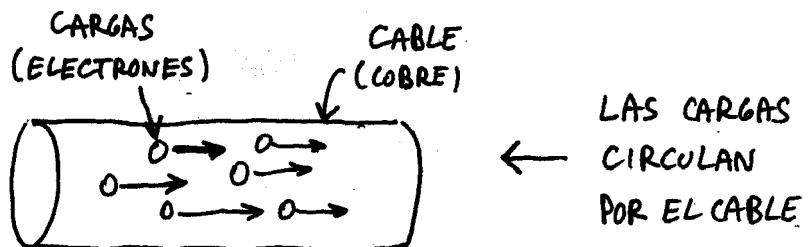
Entonces la corriente eléctrica sería el número de cargas que circulan por segundo. Hablamos de intensidad de corriente eléctrica. (I). La I Se mide en Amperes.
