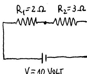
Solución: La resistencia total del circuito es  $2 \Omega + 3 \Omega = 5 \Omega$
