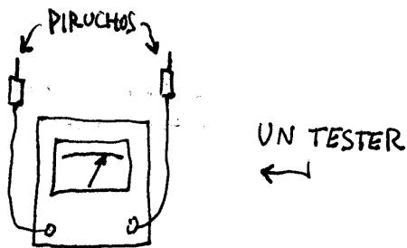
El tester tiene una palanquita que lo convierte en voltímetro, amperímetro o medidor de resistencia. Después, según como uno conecte el tester al circuito, se puede medir el voltaje, la corriente o la resistencia.
