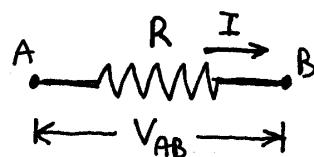
Mirá un poco el asunto: Por la resistencia circula una corriente que la llamo **I**. Esta **I** va en Amperes. Entre los bordes de la resistencia hay una tensión **V<sub>AB</sub>**. (puntos A y B). Esta tensión **V<sub>AB</sub>** es lo que se llama **caída de potencial en la resistencia**. Se mide en volts.
