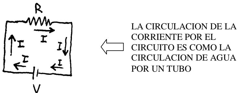
Fijate que la corriente viaja por el circuito como si fuera agua por un tubo. A lo largo del circuito no hay "corriente que se pierde". Todo el caudal que sale, es el caudal que entra. Todas las cargas que salen por un lado de la pila vuelven a entrar por el otro lado de la pila. No hay cargas que se pierdan.
