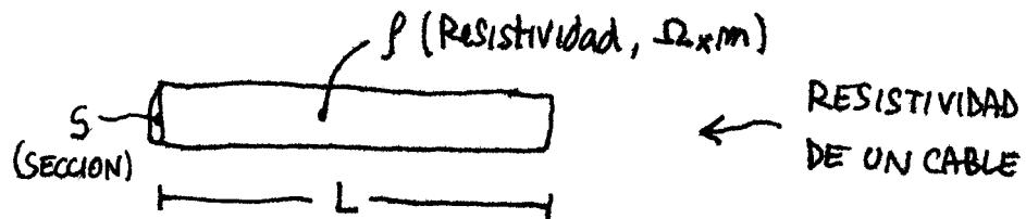
Se comprobó que la resistencia que tiene el cable es proporcional a la longitud del cable e inversamente proporcional a la sección. La fórmula es :
