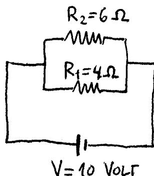
SOLUCION: Acá tengo 2 resistencias en paralelo. Calculo la resistencia equivalente
