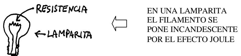
Para calcular la potencia que consume una resistencia se usa alguna de estas 3 fórmulas: Potencia =  $V \times I$  o Potencia =  $R \times I^2$  o Potencia =  $V^2 / R$ .
