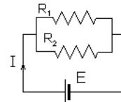
Acá la corriente tiene solamente dos caminos por donde ir (por  $R_1$  o por  $R_2$ ). La corriente total entregada por la batería será la suma la  $I_1$  y la  $I_2$ . Para calcular estas corrientes tenemos la potencia disipada en cada R, entonces hacemos:
